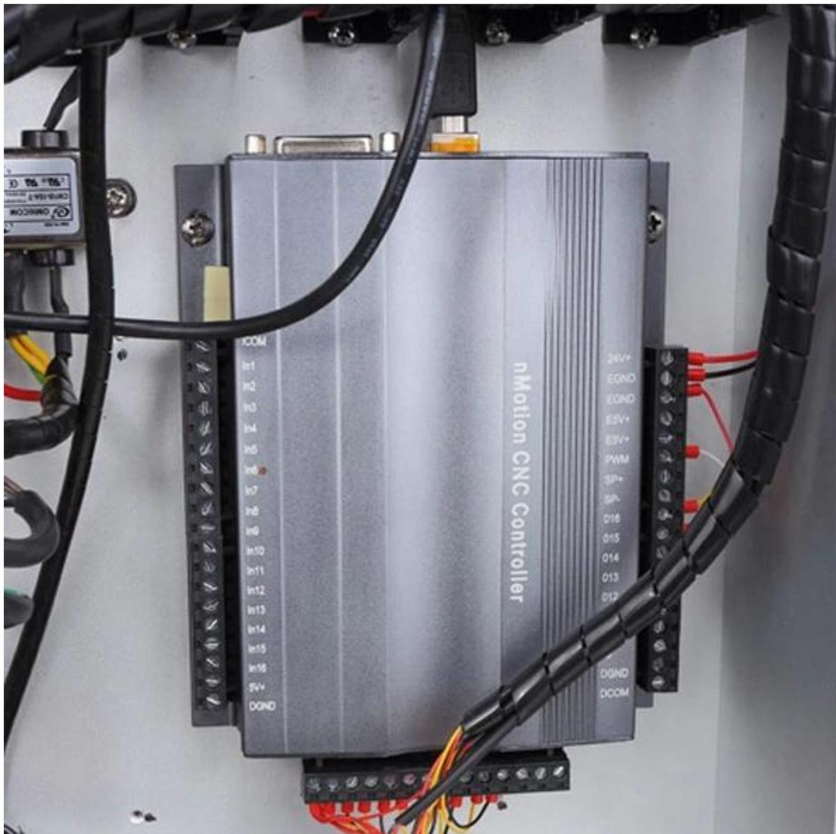
3. Cada eje está equipado con un controlador independiente, mayor precisión y eficiencia.
