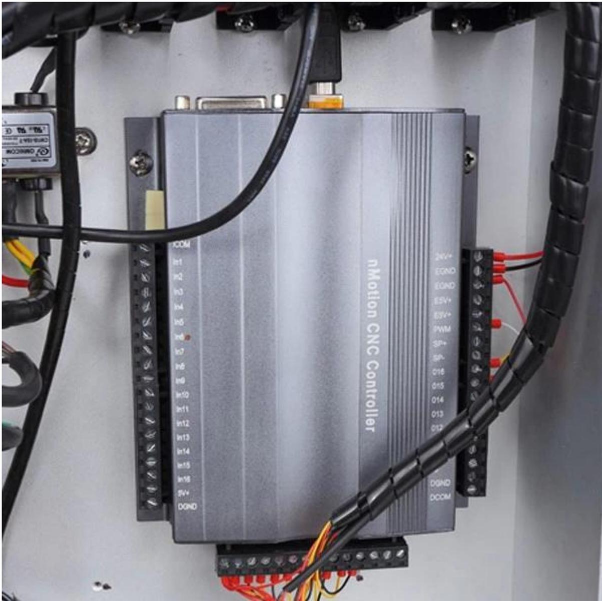
3. Jede Achse ist mit unabhängigen Treiber, höhere Genauigkeit und Effizienz ausgestattet.
